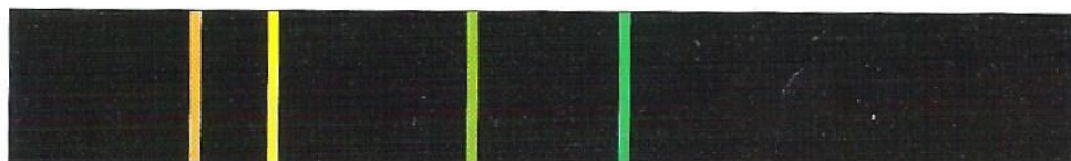
Espectro de emisión de una lámpara de sodio
