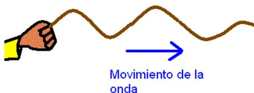
El desplazamiento de la cuerda es perpendicular a la dirección del movimiento de la perturbación, es decir, la onda se propaga a lo largo de la cuerda, mientras cada elemento de la cuerda se mueve a un lado y a otro. Las ondas de esta clase se llaman **ondas transversales**.
