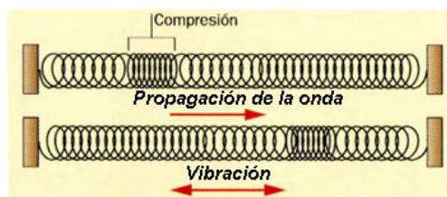
Sin embargo, las ondas producidas al comprimir y dilatar un muelle tienen la misma dirección que la perturbación (compresión-dilatación): **ondas longitudinales**.
