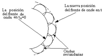
El nuevo frente de ondas es la curva que une los puntos alcanzados por las ondas secundarias (creadas en el frente de ondas a, b, c...).
