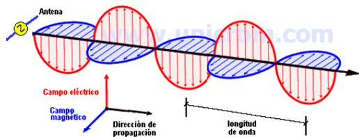
La **luz** es una onda transversal, con sus campos eléctrico y magnético variando en una dirección perpendicular a la dirección de propagación.
